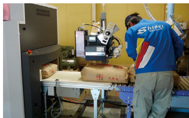
図4 玄米の全袋残留農薬検査(15秒、検出限界値は12Bq/kg)
